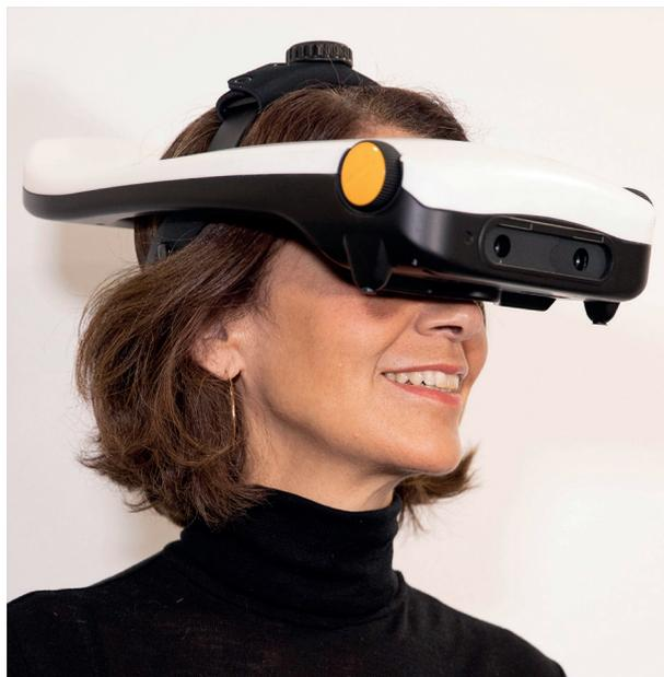
**Figura 4. Dispositivo SimVis** (<https://www.2eyesvision.com/en/simvis/>). Mediante una experiencia de visión real que mira a un entorno visual real, este dispositivo le permite al paciente experimentar la visión que puede alcanzar con diferentes modelos y diseños de lentes intraoculares.
