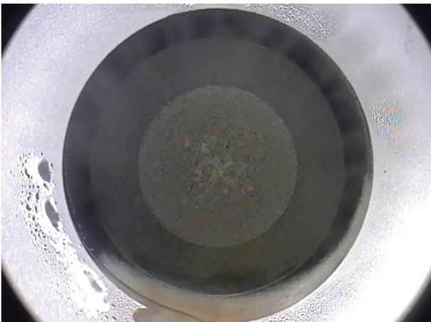
**Figura 2.** Aparición de un menisco en la zona superior durante el corte de la interfaz del cap. Se ha producido por una capa de burbujas opacas (OBL) periférica generada por el gas que se ha escapado hacia esa zona por diferencias de presión.
