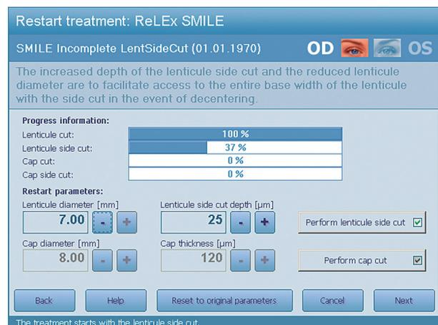
**Figura 6.** Pantalla del software VisuMax® del programa reinicio de tratamiento tras una pérdida de succión durante los cortes laterales de la interfaz lenticular. El sistema nos recomienda continuar el procedimiento desde el corte lateral. Incrementará la profundidad del mismo en 10  $\mu\text{m}$  para que coincida con la interfaz lenticular. El cirujano podría también reducir ligeramente el diámetro del lenticulo por la misma razón.
