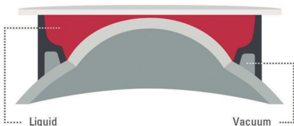
Figura 1. Interfaz líquido por inmersión exclusivo para FLACS (patentado por Ziemer).
