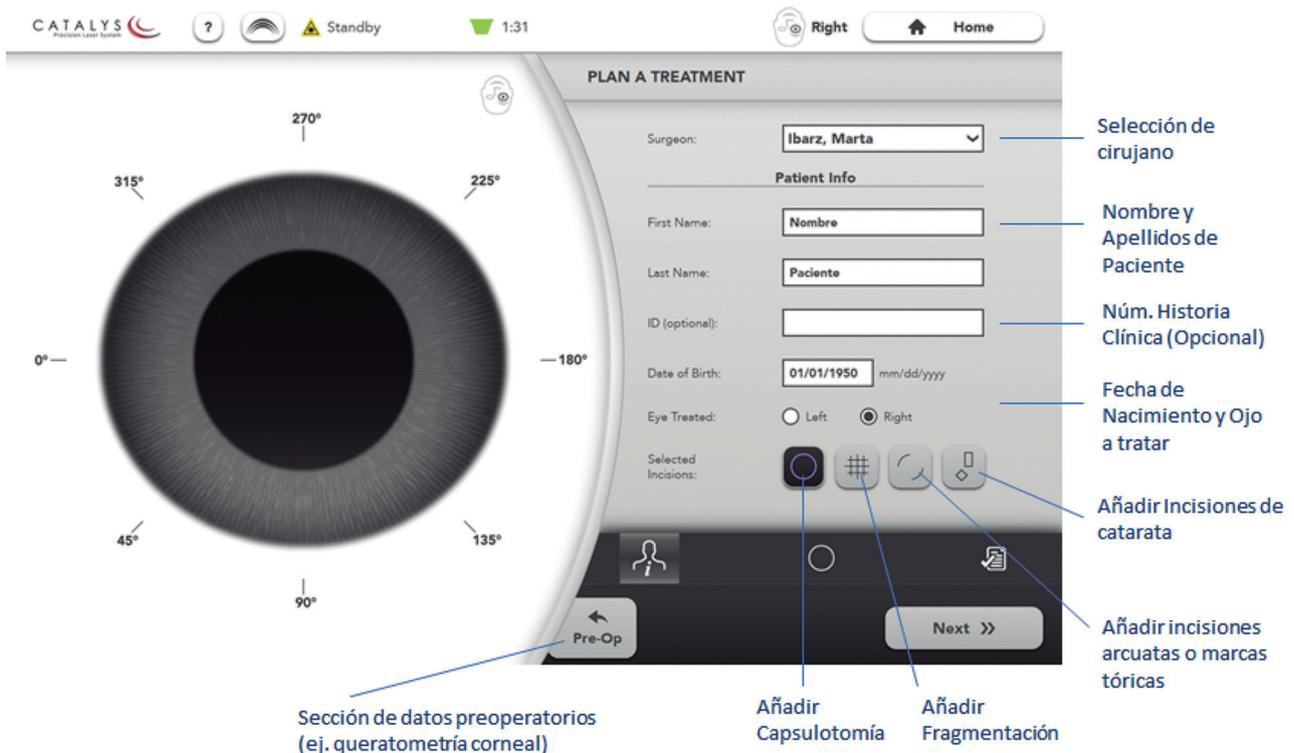
Figura 4. Pantalla «Plan a Treatment» básica del láser de femtosegundo Catalys®.
