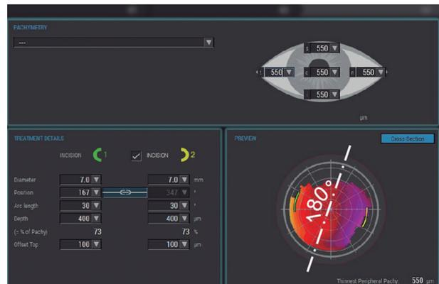
Figura 17. Pantalla de introducción de datos para la realización de dos incisiones corneales arcuatas con el LFS WaveLight® FS200.
